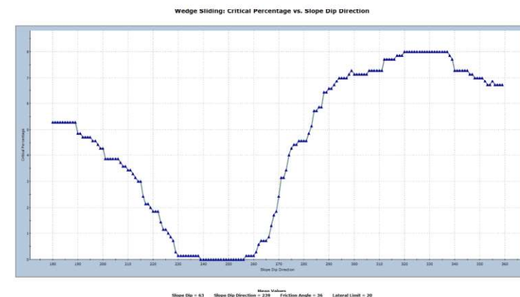
รูปที่ 24 กราฟการประเมินความอ่อนไหวระหว่างทิศทางมุมเทลาดหินหน้าเหมืองและร้อยละของภาวะวิกฤติที่จะเกิดการพังทลายของลาดหินหน้าเหมืองโซน 1
